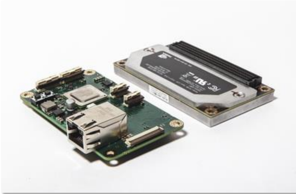
Pic.2 Jetson TX1 SoM and Phoxi carrier
